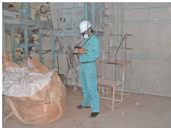
● 粉塵測定(A測定)状況
