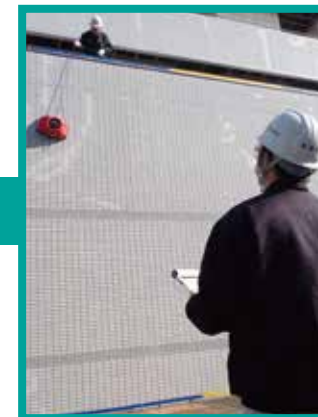
現場にて打診音から凡その浮き箇所を判定し、録画データから浮き位置を確認します。
