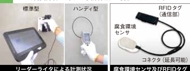
標準型 ハンディ型 RFIDタグ (通信部) 腐食環境センサ コネクタ (延長可能) リーダーライターによる計測状況 腐食環境センサ及びRFIDタグ
