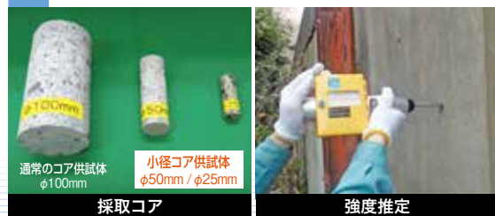
通常のコア供試体 φ100mm 小径コア供試体 φ50mm / φ25mm 採取コア 強度推定
