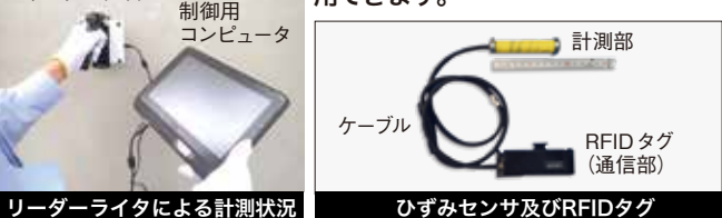
リーダーライター 制御用コンピュータ 計測部 ケーブル RFIDタグ (通信部) リーダーライターによる計測状況 ひずみセンサ及びRFIDタグ
