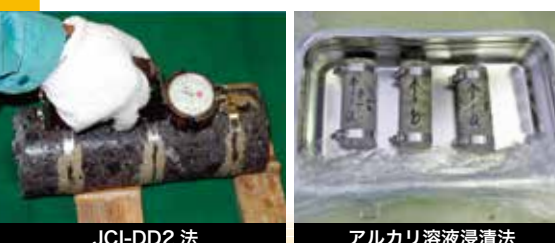
JCI-DD2法 アルカリ溶液浸漬法
