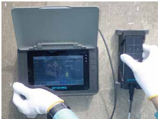
● 鉄筋探査状況
