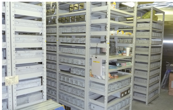
● 乾燥収縮供試体保管状況
