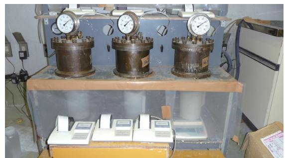
●透水量試験状況
