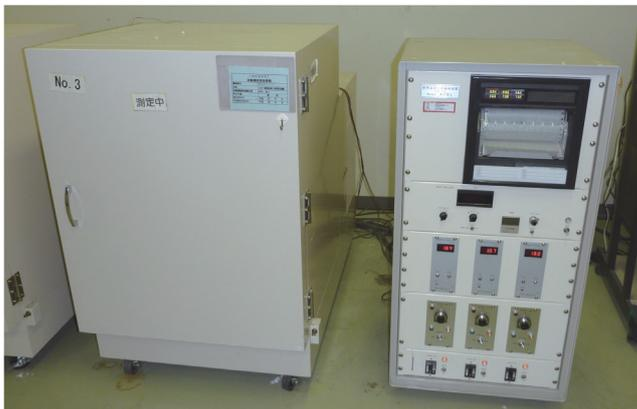
● 断熱温度上昇測定装置
