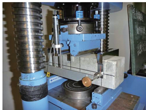
●曲げタフネス試験状況
