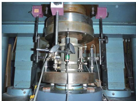
●圧縮タフネス試験状況
