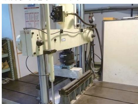
●曲げ疲労試験状況
