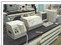
レーザー回折・散乱法による装置の一例である MICROTAC社製粒度分析計 【測定範囲】0.1~700 \mu\text{m} 【試料量】数mg程度
