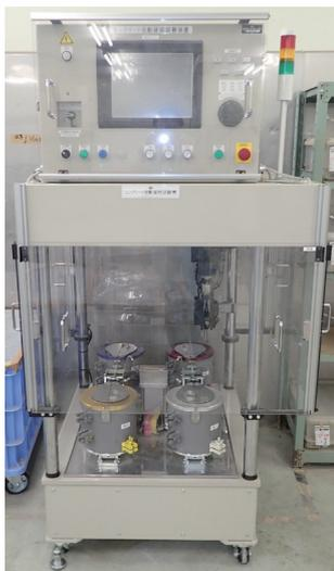
● コンクリートの自動凝結試験装置
