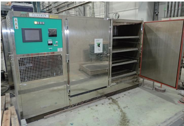
● 蒸気養生装置
