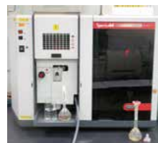
攪拌抽出(40℃温浴) 測定(原子吸光光度計)
