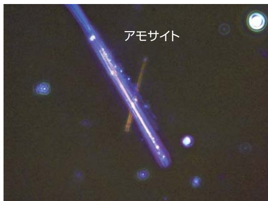
● 位相差顕微鏡観察によるアスベスト繊維の分散色
