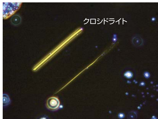
● 位相差顕微鏡観察によるアスベスト繊維の分散色
