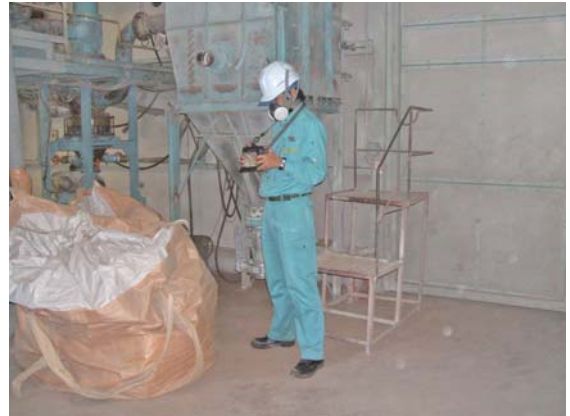
● 粉塵測定(A測定)状況
