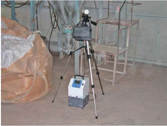
● 粉塵測定(併行測定)状況
