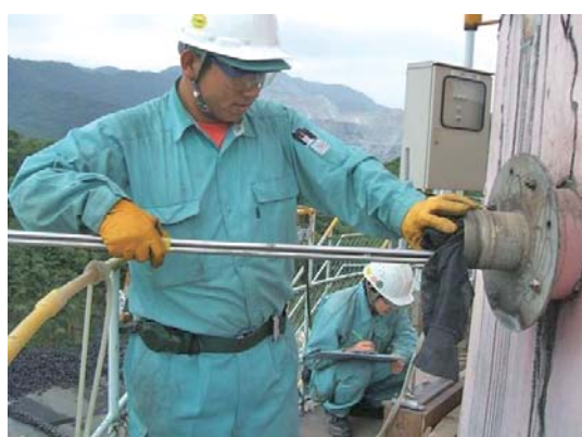
● 煙道排ガスと排出口での測定状況
