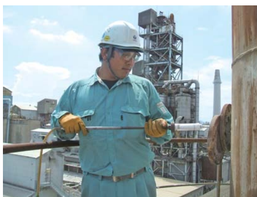
● 煙道排ガスと排出口での測定状況
