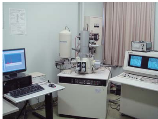
●SEM装置の外観
