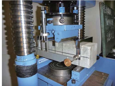
●曲げタフネス試験状況
