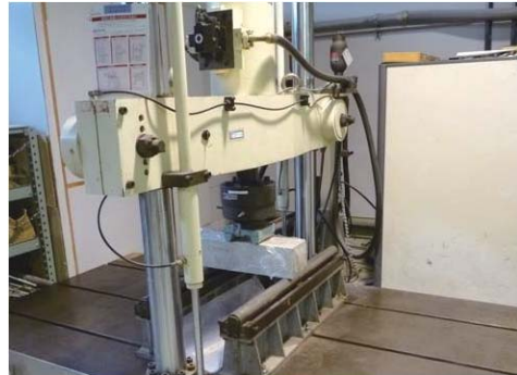
●曲げ疲労試験状況
