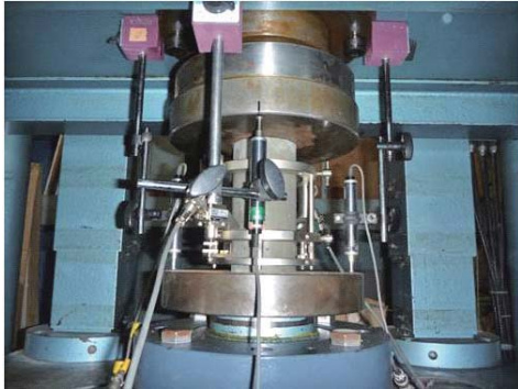
●圧縮タフネス試験状況
