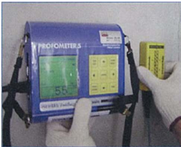
●鉄筋探査状況
