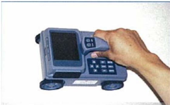
●鉄筋探査状況
