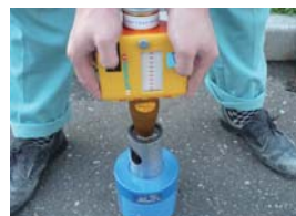
●テストアンビルによる 点検
