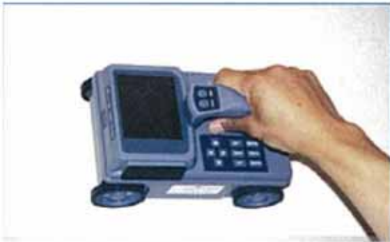
●鉄筋探査状況
