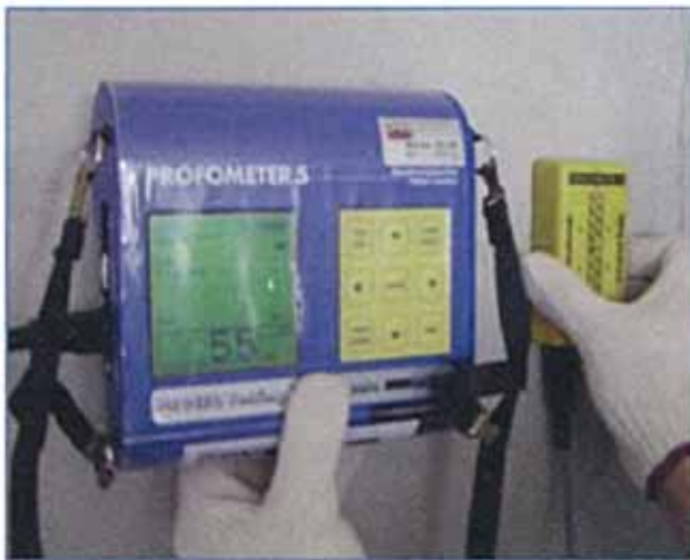
●鉄筋探査状況
