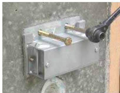
写真 1.3 ボス供試体の割取り
