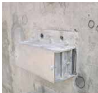
写真 1.2 成型されたボス供試体
