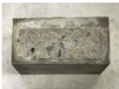
写真 1.4 脱型後のボス供試体
