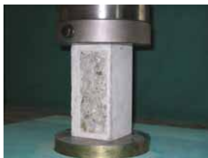
写真 1.5 ボス供試体の圧縮試験状況
