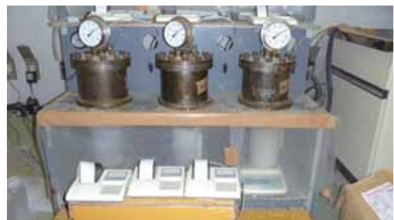
●透水量試験状況
